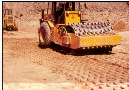
Figura 10.7.2 Aspecto de un equipo típico de compactación por amasado
