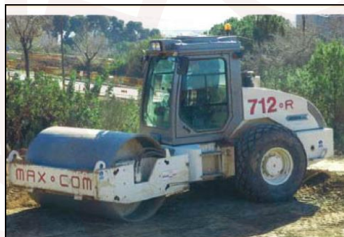
Figura 10.7.1 Aspecto de un equipo típico de compactación por vibración-compresión
